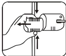
Для снятия плафона освещения слегка сожмите его, чтобы фиксаторы вышли из зацепления и затем удалите плафон.
